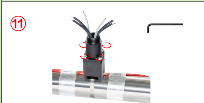
11 : Comprimer le joint d'étanchéité en vissant à fond la partie supérieure du pied avec les 4 vis jusqu'au moment où les deux parties du pied se touchent.
